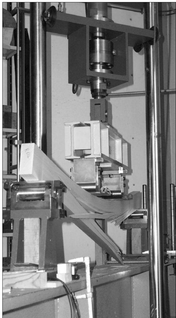
Figure 3. Prova di flessione statica, secondo la norma EN408. Figure 3. Bending test, according to the standard EN408.
