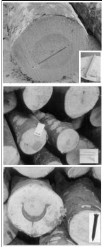
Figura 1. Esempi di tags RFID idonei alla marcatura del legname (tag sperimentale a cuneo, clip, nail tag). Figure 1. Examples of RFID tags for timber marking (experimental wedge tag, clip, nail tag).
